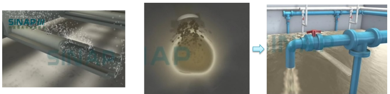
图 9 曝气管及曝气孔清洗示意图
